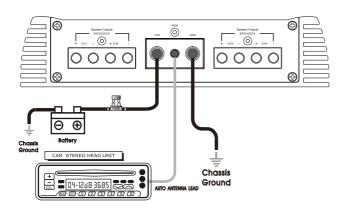
+12V所使用的电线必须是高规格的镀铜绝缘线材, 因为它与电源的正极末端直接连接. 线材横截面面积至少在10mm². 接地的电线需与+12V的一致。
